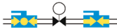
DISPOSITIVO DI REGOLAZIONE - REGULATING DEVICE VANNE DE REGULATION - REGELVENTIL DISPOSITIVOS DE REGULACIÓN
