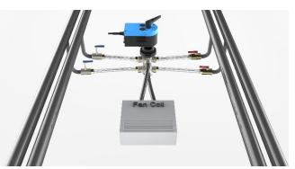
La seule et simultanée rotation de 90° des deux sphères permet d'ouvrir l'aller et le retour d'une côté (par exemple les voies n°1 et n°4) et en même temps de fermer l'autre côté (voies n°5 et n°6), donc en évitant aucun le mélange des deux flux.
