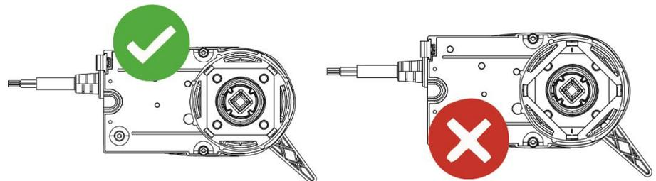
2. Posizionare l'asta di comando della valvola a 6 vie serie 63 in posizione 90° ovvero in maniera tale che siano chiuse le vie 1 e 4, e completamente aperte le vie 5 e 6
