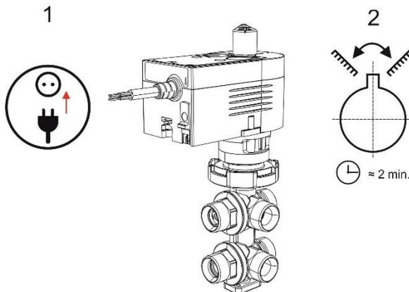
**Modalità di controllo 2 punti:** appena messo in tensione il motore **M63** individua automaticamente la posizione 100% ovvero vie 1 e 4 completamente chiuse. Solo l'intervento del sistema di controllo (es. Termostato ambiente) può modificare questa situazione e procedere all'apertura delle vie 1-4 a discapito delle vie 5-6
