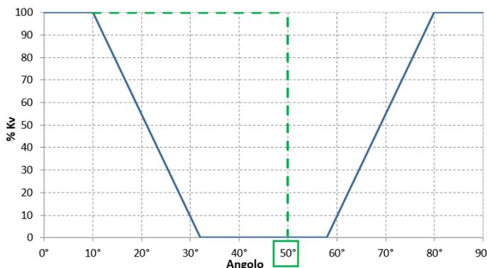
Il diagramma riportato qui di lato rappresenta la curva di funzionamento caratteristica della valvola a sei vie 63/2E in funzione della rotazione del sistema asta/sfere. Il dispositivo di scarico delle sovrappressioni opera fino a 50°, come mostrato a fianco.
