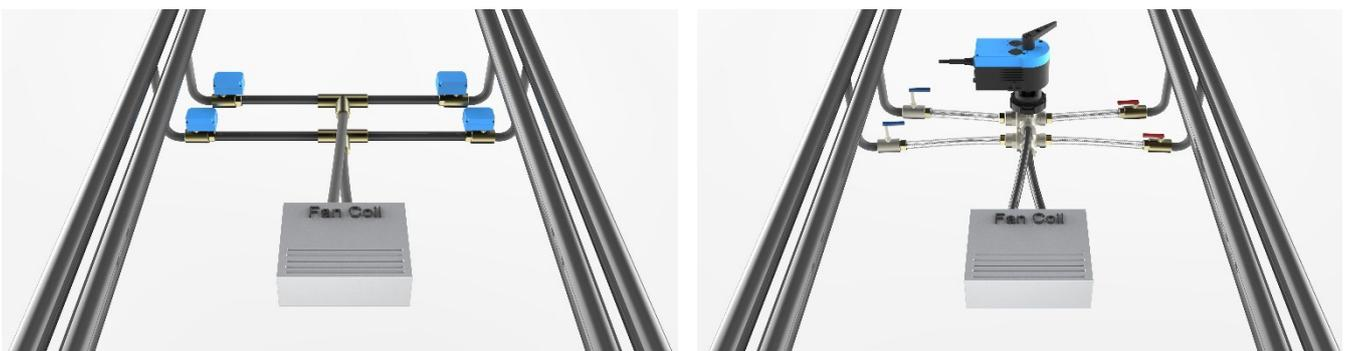
La semplice e simultanea rotazione di 90° delle due sfere consente di abilitare andata e ritorno di una "sezione" (per esempio vie n°1 e n°4) e contemporaneamente chiudere a tenuta l'altra "sezione" (vie n°5 e n°6) evitando perciò la miscelazione fra i due flussi.
