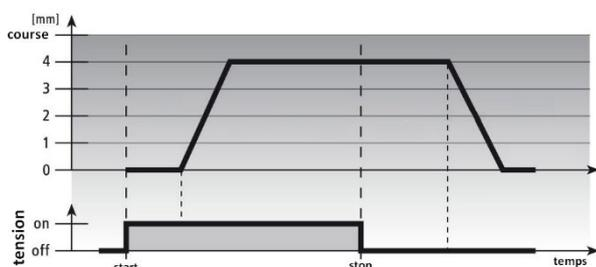
Le schéma représente la caractéristique de fonctionnement de la commande thermoélectrique V542O2 230V ON/OFF-PWM N.C.
