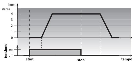
Nel diagramma qui riportato è rappresentata la curva caratteristica di funzionamento del comando elettrotermico V54202 230V ON/OFF - PWM N.C. (normalmente chiuso).
