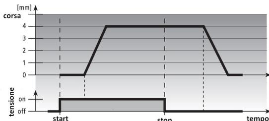
Nel diagramma qui riportato è rappresentata la curva caratteristica di funzionamento del comando elettrotermico V54402 24V ON/OFF - PWM N.C. (normalmente chiuso).
