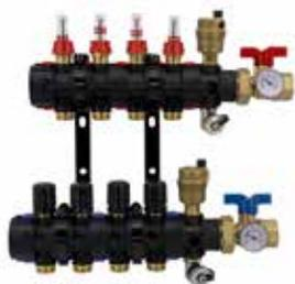
Collettore modulare premontato in PA66/ottone, con zanche di supporto, flussometro, valvola di mandata e valvola di ritorno 1" F , termometro (T39P/80), con valvole di scarico e sfogo aria automatico.
