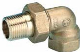
Raccordo curvo in 3 pezzi femmina/maschio. Tenuta metallica. A norme DIN 3842. Versione gialla.
