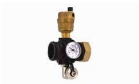
Gruppo terminale in materiale sintetico PA66 e ottone composto da un terminale a "T", sfogo aria automatico, valvola di drenaggio e termometro. Disponibile con connessioni da 1" o 1 1/4" sede piana, calotta folle.
