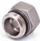
Raccordo esterno (1" M con O-ring x 1" F dado girevole sede piana) per collettori in acciaio inox per installazione in ingresso e uscita di valvole a sfera 1" M a sede piana.
