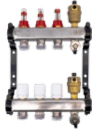
Collettore in acciaio INOX AISI 304L con misuratore di flusso, sfiato automatico e valvola di drenaggio. Portata: da 1 l/min a 5 l/min.
