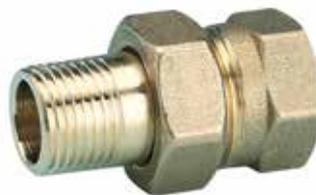
Raccordo diritto in 3 pezzi femmina/maschio. Tenuta metallica. A norme DIN 3842. Versione gialla.
