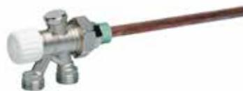
Valvola termostattizzabile a 4 vie mono-bitubo. Attacco a compressione. Nichelata. Senza raccorderia di collegamento (Art. 3625 - 3015 - 3015SCR - 3525). Con sonda da 40 cm.
