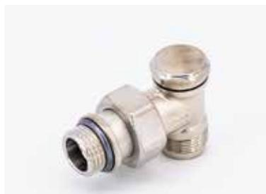
Detentore a regolazione micrometrica del radiatore. A squadra. Attacco a compressione. Nichelato. Senza raccorderia di collegamento (Art. 3015 - 3015SCR - 3625 - 3525).
