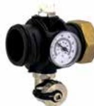
Gruppo terminale in materiale sintetico PA66 e ottone composto da un terminale a "T", sfogo aria manuale, valvola di drenaggio e termometro. Disponibile con connessioni da 1" o 1 1/4" sede piana, calotta folle.
