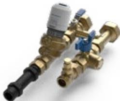
Kit hidronico "Energy Saver Compact" Pettinaroli para contabilización y facturación de energía termica en instalaciones de agua para sistemas de aire acondicionado y calefacción. El kit incluye picv "DYNASTY" con tomas de presión, para aguas duras y simple mantenimiento, FilterBall Pettinaroli (válvula de corte con filtro incluido), by-pass para limpieza de la tubería principal con válvulas de corte y sonda de temperatura en la impulsión. Probado y con garantía desde Pettinaroli.
