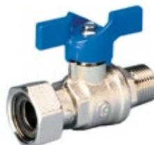
Válvula de corte para contadores de agua con mando a mariposa azul. Esfera anti legionela con orificio adicional en la parte inferior: evita el estancamiento de agua en la cavidad del cuerpo de la esfera. Válvula acabada con proceso TEA (Ternary Eco Alloy), compuesto intermetálico que permite evitar que la válvula libere níquel en el agua. Especial para uso sanitario.
