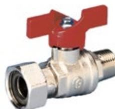
Válvula de corte para contadores de agua con mando a mariposa rojo. Esfera anti legionela con orificio adicional en la parte inferior: evita el estancamiento de agua en la cavidad del cuerpo de la esfera. Válvula acabada con proceso TEA (Ternary Eco Alloy), compuesto intermetálico que permite evitar que la válvula libere níquel en el agua. Especial para uso sanitario.
