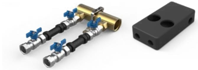
Kit UC/FC para la contabilización de agua fría sanitaria (A.F.S.) en sistemas centralizados de 2 y 3 salidas. El kit se compone de: dos válvulas de corte, dos válvulas de corte con anti retorno y colector de 1.1/4". Aislamiento completo incluido en el kit. El montaje entre kits se puede realizar con la unión "OUC/C" (pagina 100)
