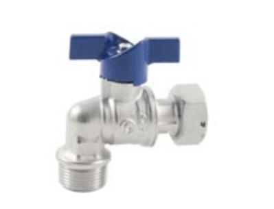
válvula de corte angular para contadores de agua con mando a mariposa azul. Esfera anti legionela con orificio adicional en la parte inferior: evita el estancamiento de agua en la cavidad del cuerpo de la esfera.
