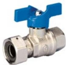
Válvula de corte para contadores de agua con mando a mariposa azul. Esfera anti legionela con orificio adicional en la parte inferior: evita el estancamiento de agua en la cavidad del cuerpo de la esfera. Válvula acabada con proceso TEA (Ternary Eco Alloy), compuesto intermetálico que permite evitar que la válvula libere níquel en el agua. Especial para uso sanitario.
