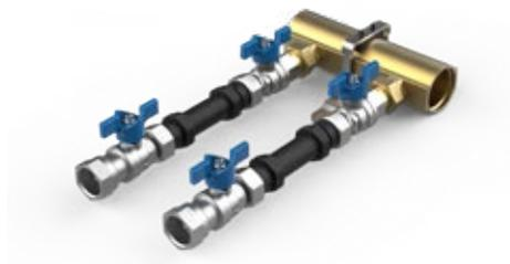
Kit UC/FC para la contabilización de agua fría sanitaria (A.F.S.) en sistemas centralizados de 2 y 3 salidas. El kit se compone de: dos válvulas de corte, dos válvulas de corte con anti retorno y colector de 1.1/4". El montaje entre kits se puede realizar con la unión "OUC/C" (pagina 100)
