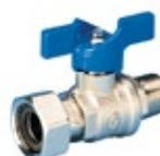
Válvula de corte para contadores de agua con anti retorno incorporado y mando a mariposa azul. Esfera anti legionela con orificio adicional en la parte inferior: evita el estancamiento de agua en la cavidad del cuerpo de la esfera. Válvula acabada con proceso TEA (Ternary Eco Alloy), compuesto intermetálico que permite evitar que la válvula libere níquel en el agua. Especial para uso sanitario.
