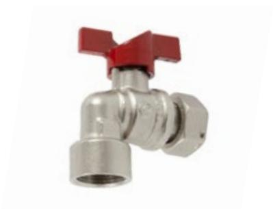
Válvula de corte angular para contadores de agua con mando a mariposa rojo. Esfera anti legionela con orificio adicional en la parte inferior: evita el estancamiento de agua en la cavidad del cuerpo de la esfera.
