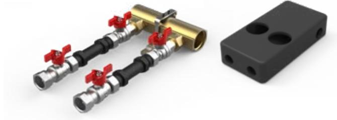
Kit UC/FC para la contabilización de agua caliente sanitaria (A.C.S.) en sistemas centralizados de 2 y 3 salidas. El kit se compone de: dos válvulas de corte, dos válvulas de corte con anti retorno y colector de 1.1/4". Aislamiento completo incluido en el kit. El montaje entre kits se puede realizar con la unión "OUC/C" (pagina 100)
