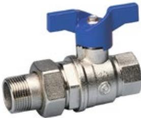
Válvula de esfera paso total con conexiones M x racor manguito H (bsp), triple seguridad en el eje y prensaestopas regulable. Maneta de aluminio azul. Conforme a EN13828
