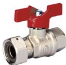
Válvula de corte para contadores de agua con mando a mariposa rojo. Esfera anti legionela con orificio adicional en la parte inferior: evita el estancamiento de agua en la cavidad del cuerpo de la esfera. Válvula acabada con proceso TEA (Ternary Eco Alloy), compuesto intermetálico que permite evitar que la válvula libere níquel en el agua. Especial para uso sanitario.
