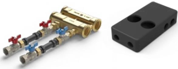
Kit UC/FC para la contabilización de agua caliente sanitaria (A.C.S.) y agua fría sanitaria (A.F.S.) en sistemas centralizados. El kit se compone de: dos válvulas de corte, dos válvulas de corte con anti retorno, colector coplanar de 1.1/4" y aislante completo.
