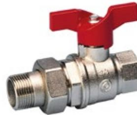
Válvula de esfera paso total con conexiones M x racor manguito H (bsp), triple seguridad en el eje y prensaestopas regulable. Maneta de aluminio roja. Conforme a EN13828
