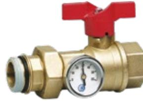
Válvula de esfera hembra X racor-manguito y predisposición de termómetro (ref. T40/60, no incluida con la válvula). Paso total. Mando mariposa rojo
