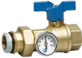
Válvula de esfera hembra X racor-manguito y predisposición de termómetro (ref. T40/60, no incluida con la válvula). Paso total. Mando mariposa azul
