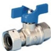
Válvula de corte para contadores de agua con anti retorno incorporado y mando a mariposa azul. Esfera anti legionela con orificio adicional en la parte inferior: evita el estancamiento de agua en la cavidad del cuerpo de la esfera. Válvula acabada con proceso TEA (Ternary Eco Alloy), compuesto intermetálico que permite evitar que la válvula libere níquel en el agua. Especial para uso sanitario.
