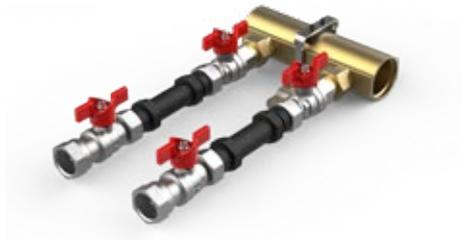
Kit UC/FC para la contabilización de agua caliente sanitaria (A.C.S.) en sistemas centralizados de 2 y 3 salidas. El kit se compone de: dos válvulas de corte, dos válvulas de corte con anti retorno y colector de 1.1/4". El montaje entre kits se puede realizar con la unión "OUC/C" (pagina 100)
