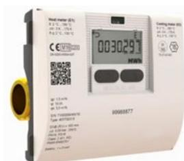
Contador de energía térmica Pettinaroli ultrasonidos para calefacción y refrigeración componible con paquetes diferentes. Alimentación: 24VAC, 230VAC o baterías. Disponible en los siguientes protocolos de comunicación: BACnet, M-bus, MODBUS, LoraWan o Wireless M-bus. Con sonda de temperatura incorporada y certificado según normativa MID (directiva Europea). Conexiones roscadas macho con asiento llano.
