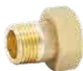
Douille 3/4" F sphéro conique écrou tournant x 1/2" M
