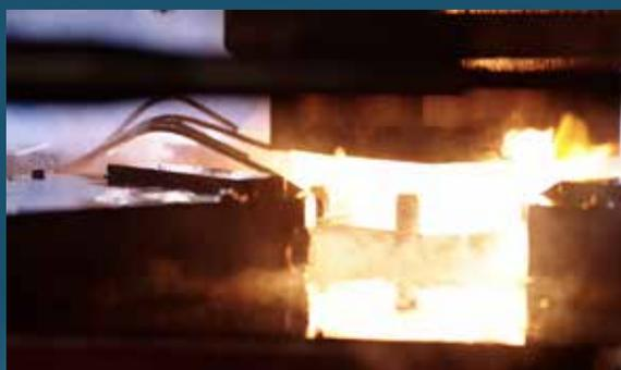
Le verghe vengono tagliate e le billette così ricavate vengono **riscaldate e pressate**, utilizzando stampi appositamente progettati. Dopo la formatura, i pezzi risultanti vengono **tranciati e sottoposti a sabbiatura** per ottenere una superficie liscia e uniforme.
