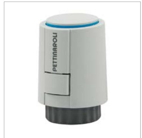
Posiciones de montaje: cualquier posición entre la vertical y la horizontal. Tiene que evitarse el montaje de arriba abajo (actuador debajo de la válvula).
