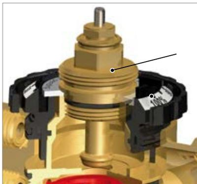
Interviniendo en la posición del vástago de control A de la válvula de regulación se modifica el  $K_v$  de la válvula y, por lo tanto, el caudal. La relación entre  $K_v$  y la carrera se muestra en el gráfico siguiente.
