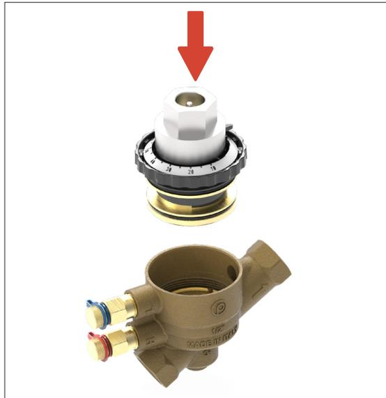
Etape 9: visser la vanne de contrôle avec un couple de 15/20 Nm jusqu'à atteindre la position initiale de la tige de blocage
