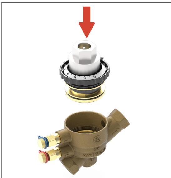
Step 9: avvitare la valvola di controllo con una coppia massima di 15/20 Nm fino a raggiungere la posizione originaria dell'indicatore di presetting
