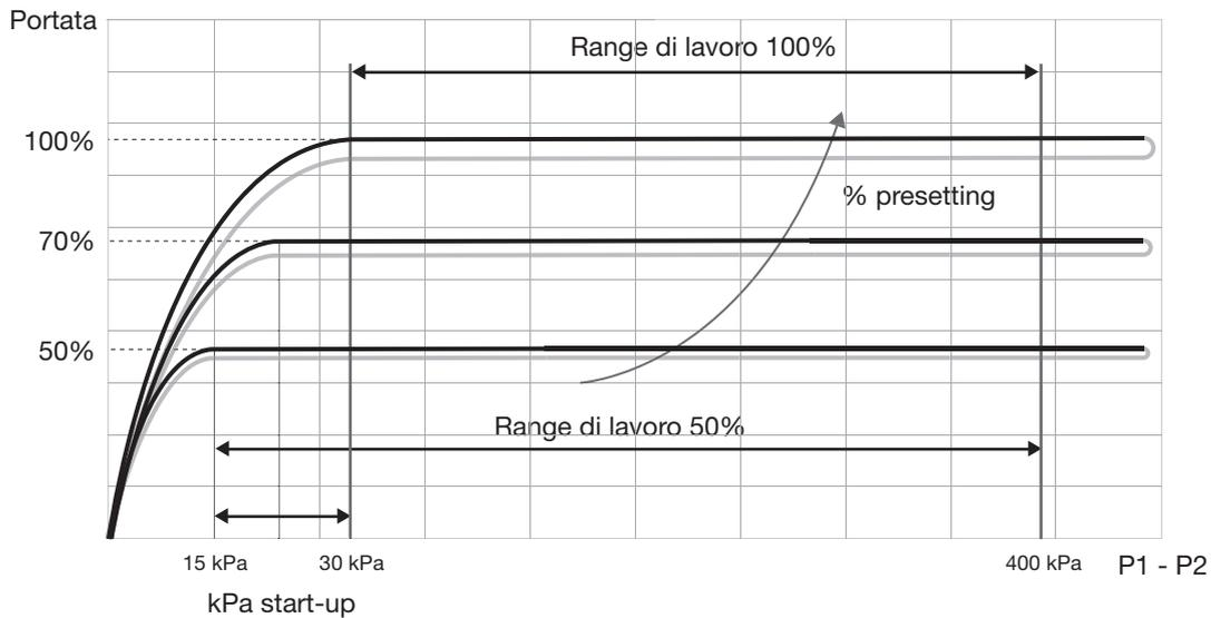
Quando il presetting della valvola è regolato al 100% della portata nominale, la curva caratteristica resta costante dopo la pressione di 30 kPa. Il range di lavoro della valvola è di 30-400kPa.
