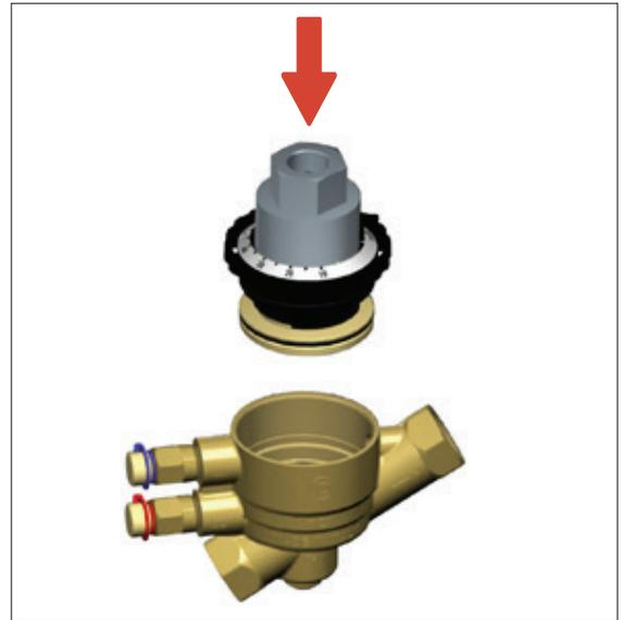
Step 9: avvitare la valvola di controllo con una coppia massima di 15/20 Nm fino a raggiungere la posizione originaria dell'indicatore di presetting
