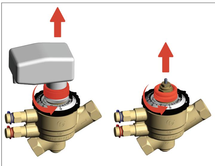
Step 2: posizionare l'adattatore per chiave 26 mm fornito sul vitone. Allineare con l'indicatore
