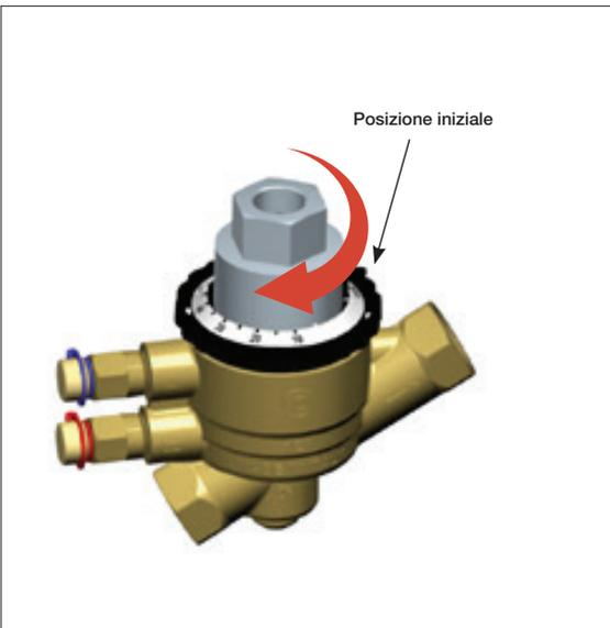
Step 10: rimuovere l'adattatore da 26 mm e riposizionare adattore/attuatore oppure la manopola
