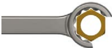
Llave para tuerca cónica de 30 mm, modificada con ranura de 30 mm.
