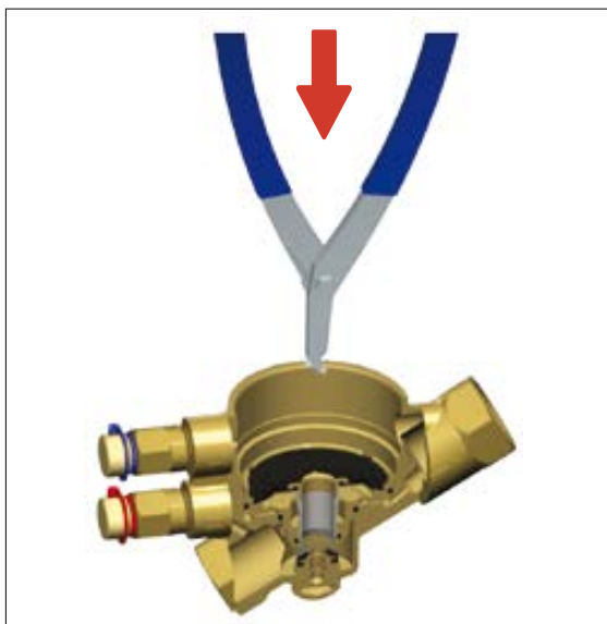
Paso 5: Introducir los alicates a través del centro del cartucho
