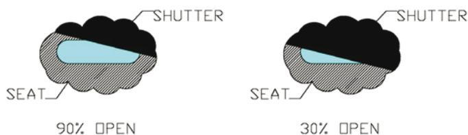
*Indication du fonctionnement de l'élément de pré réglage*
