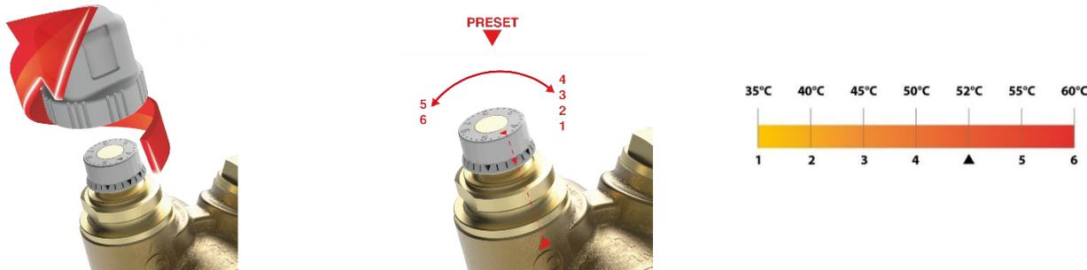
Il s'agit d'une opération simple mais importante pour le bon fonctionnement du système. Il est toujours conseillé de pré-régler les vannes du système à une valeur de température supérieure à 3-5°C par rapport à la température réellement souhaitée chez les utilisateurs les plus défavorisés. De cette manière, les pertes de charge globales seront limitées au profit du choix du circulateur dédié au réseau de recirculation.
