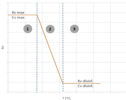
**Zone 1 - Fonctionnement aux valeurs  $K_{vmax}$** , c'est-à-dire lorsque le  $T_{eau} \ll T_{presetting}$
