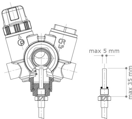
Les vannes d'équilibrage de la série TB20 – TB20-2 sont conçues pour recevoir une sonde de température à immersion (non fournie) équipée en standard d'un puits fileté mâle M10. Remplacez simplement le bouchon par l'adaptateur spécifique OTB02 ½" M x M10 F vendu séparément (en option). **Il est recommandé de respecter les limites maximales de longueur et de diamètre décrites ci-contre.**
