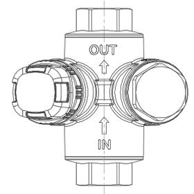
Comme pour tous les types de vannes d'équilibrage (qu'elles soient destinées aux systèmes de climatisation ou comme dans ce cas aux systèmes de distribution sanitaire), afin d'éviter les problèmes de fonctionnement, il est toujours recommandé d'installer des moyens de capacité de filtrage adéquate sur les systèmes tels que les 51F - vannes à bille FILTERBALL avec filtre incorporé.
