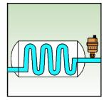
Le clapet du produit **696/97** permet de démonter le purgeur (pour son entretien ou substitution) sans vider l'installation.
