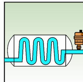
La valvola di non ritorno del prodotto **696/97** consente di smontare la valvola di sfogo aria automatica (per la sua manutenzione o sostituzione) senza svuotare l'impianto.
