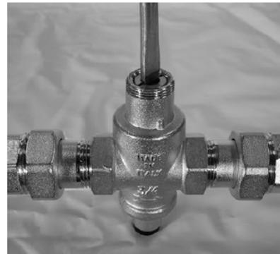
Per evitare sovrappressioni (con conseguente apertura della valvola di sicurezza), colpi d'ariete e ritorni di flusso causati da un incremento del volume dell'acqua calda (ciò può avvenire quando un boiler elettrico, un mixer o un accumulatore di acqua calda è installato a valle del riduttore), si consiglia di installare una valvola di ritegno e un vaso di espansione tra il dispositivo di riscaldamento e il riduttore di pressione, come mostrato sotto.
